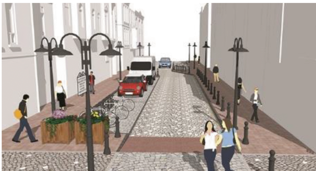
Figura 3.17. Amenajarea corectă a trotuarului – delimitat de zonele în care pot fi parcate autovehiculele.
