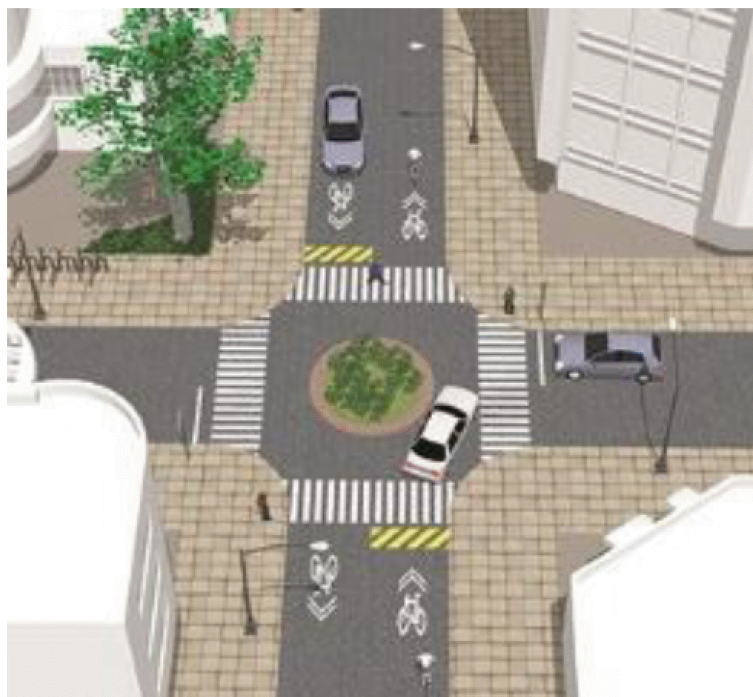
Figura 3.14. Amenajarea de insule centrale în intersecții.
