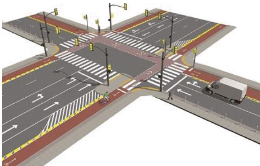
Figura 3.17. Amenajarea unei intersecții semaforizate cu semnal controlat.
