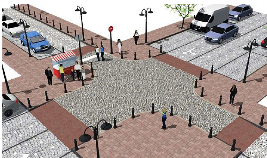
Figura 3.13. Înălțarea cotei în zona intersecțiilor și trecerilor de pietoni.
